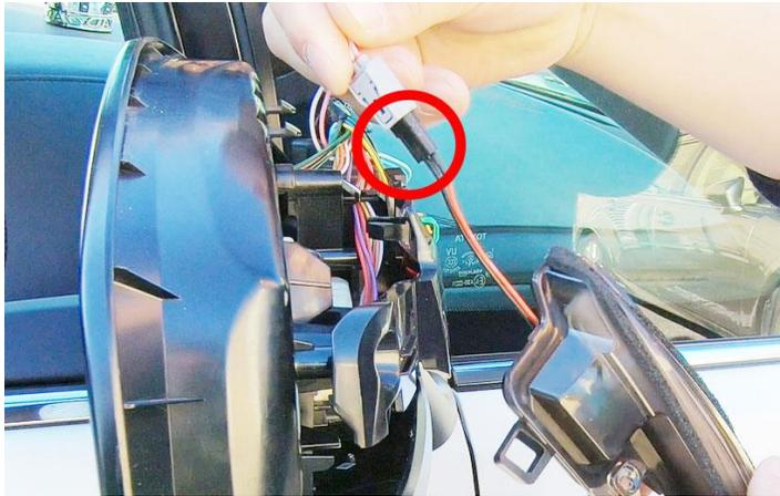
ミラーカバーの取り外しの際、非常にツメが割れやすいので、ご注意ください。下記画像の赤丸部分の3点のツメを解除し、カバーを取り外して下さい。取り外し・取り付けの際の傷や破損等の保証はできかねます。ご了承下さい。
